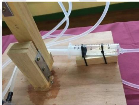
圖 7 汐止國中採用連桿式轉盤 圖 8 華山國中使用鉸鏈組合底座與第一主桿
