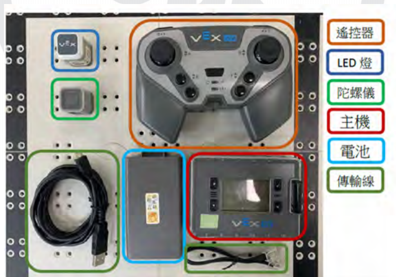
圖 8. 控制與感測器設備
