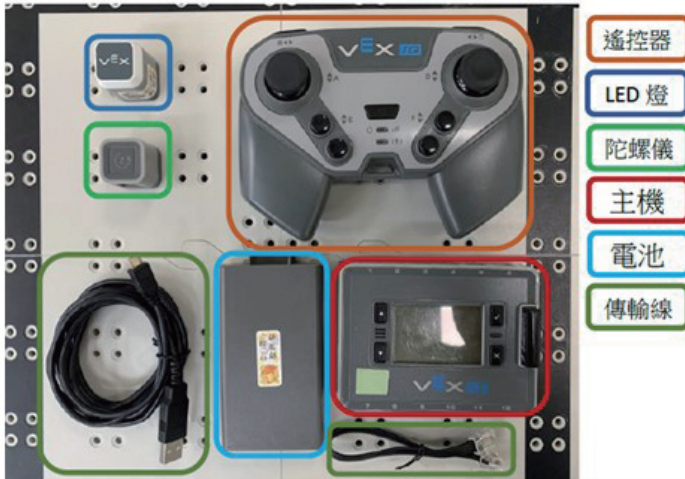
圖 5 控制與感測器設備
