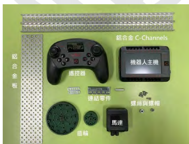
圖 6. V5 基本結構材料示意圖
