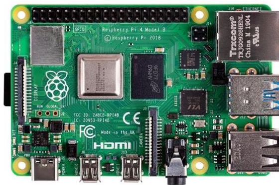
圖 2. 樹莓派 (Raspberry Pi 4 Model B)
