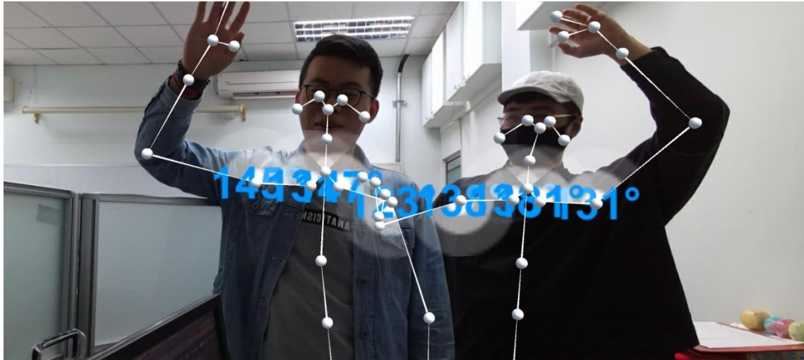
圖 14. 計算使用者肩關節骨架角度
