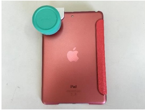
圖 2.生物顯微鏡與平板電腦示意圖
